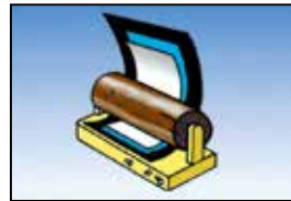
4. 下からホルダー (黒)、パー ルフィルム、原稿の順に重ね て巻き、しっかりと止めます。
