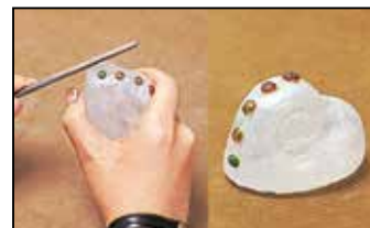
8. ガラスの余分な部分(バリ)などを砥石や電動研磨機でけずり落とし、完成です。
