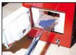
7. 裏引きをして乾燥後、焼成します。(裏引き絵の具はCMC混入済なので水に溶かすだけでOK)
