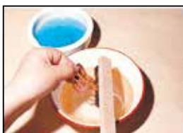
6. 再びディクセル溶液で洗い、水を流しながら真ちゅうブラシで軽く磨きます。
