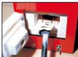
2. 銅板を七宝炉に入れ赤くなるまで熱し(約30秒)、炉から出して自然に冷やします。(焼きなまし)
