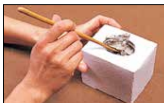
4. 完全に乾燥したら、中の油粘土を抜き取ります。
