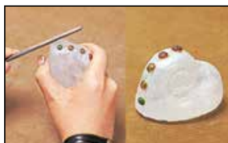
8. ガラスの余分な部分(バリ)などを砥石や電動研磨機でけずり落とし、完成です。
