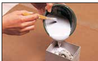
3. 型取り用箱を組み立てて枠を作り、作品の中に置き、耐火石こうを流しこみます。
