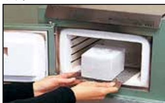
6. 電気炉に入れ、800℃～850℃で約15～25分焼成します。その後600℃まで下げ、スイッチを切ります。
