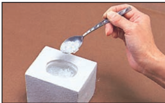
5. 型に水で練った色ガラス粉を塗り、その上にカレットを山盛り状に入れます。(焼成後、容量が約2割減ります。)
