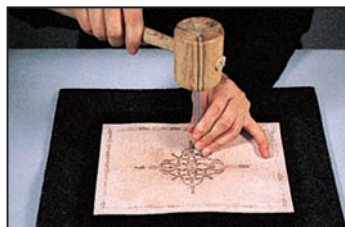
3. スーベルカッターでカットしたり、モデラで輪郭線を際立たせます。この後、刻印棒を使い、打刻します。
