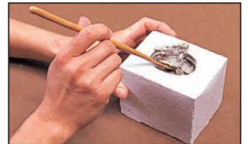
4. 完全に乾燥したら、中の油粘土を抜き取ります。
