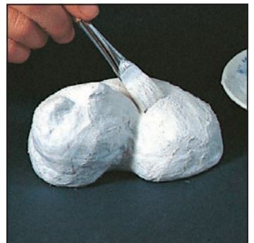
4. 原形を抜き取ったら、再び元どおりに張り合わせます。
