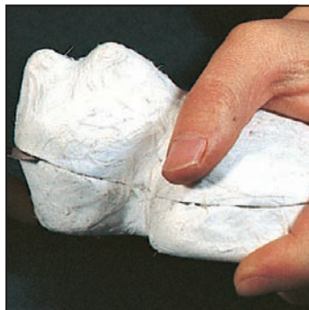
3. 乾燥後、カッターナイフで切り開き、原形を抜き取ります。
