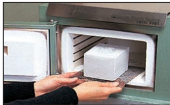
6. 電気炉に入れ、800℃～850℃で約15～25分焼成します。その後600℃まで下げ、スイッチを切ります。
