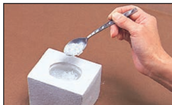
5. 型に水で練った色ガラス粉を塗り、その上にカレットを山盛り状に入れます。(焼成後、容量が約2割減ります。)
