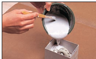
3. 型取り用箱を組み立てて枠を作り、作品を中に置き、耐火石こうを流しこみます。
