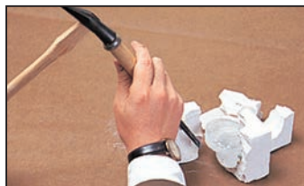
7. 徐冷中は電気炉の扉は開けず、翌日冷たくなった石こうの型を取り出し、型をこわします。作品を水で洗います。
