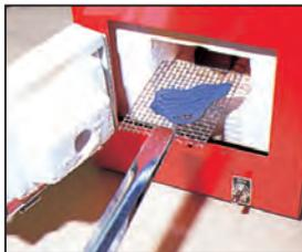
7. 裏引きをして乾燥後、焼成します。（裏引き絵の具はCMC混入済なので水に溶かすだけでOK）
