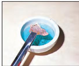
3. ディクセル溶液（コップ一杯の水にディクセル大さじ4杯を入れガラス棒などでかきまぜて溶かす）に漬けておきます。
