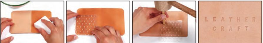
1. スポンジに水を含ませ、打刻する革の上に刻印シートを乗せ、位置を合わせて軽く数回叩きます。
