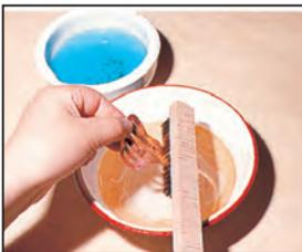
6. 再びディクセル溶液で洗い、水を流しながら真ちゅうブラシで軽く磨きます。
