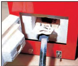
2. 銅板を七宝炉に入れ赤くなるまで熱し（約30秒）、炉から出して自然に冷やします。（焼きなまし）
