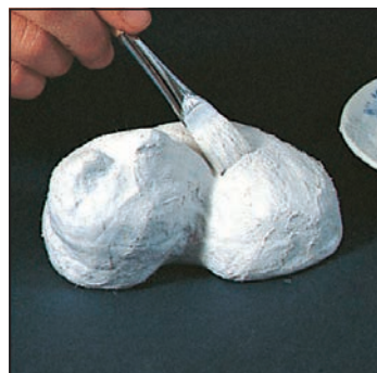
4. 原形を抜き取ったら、再び元どおりに張り合わせます。
